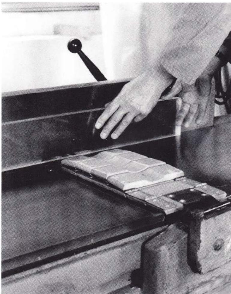
Рис. 36. Сглаживание торца на продольно-строгальном станке
