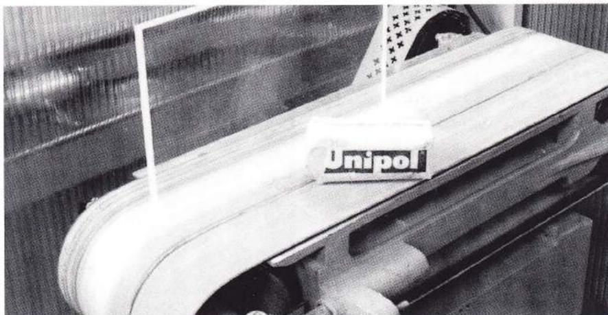
Рис. 39. Полировка войлочной лентой
