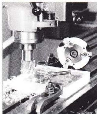
Рис. 24. Фрезерование PLEXIGLAS® цилиндрической фрезой; различные типы фрез: а – двухкромочная, б – цилиндрическая, с – алмазная
