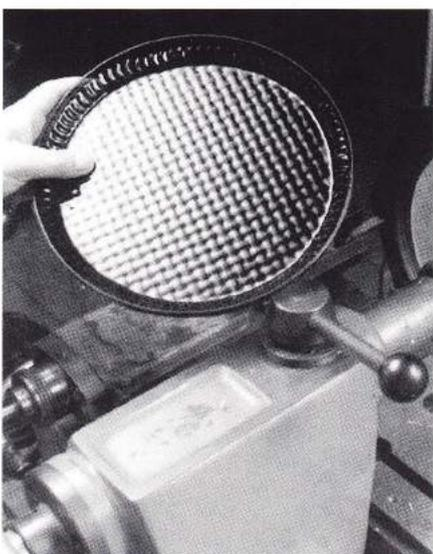
Рис. 34. Обрезание краев отформованного изделия
